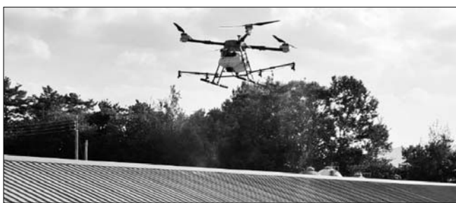
정읍시가 축산농가의 폭염 피해 최소화를 위해 전라북도 최초로 '드론 활용 축사 지붕 열 차단제 도포 시범사업'을 추진한다.
