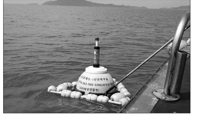
부안군은 지난해 10월 기상관측장비 설치사업에 착수해 최근 격포-위도간 해역에 실시간 기상정보 수집이 가능한 파고부이를 설치하고 시험운영 중이다.
