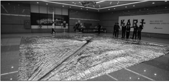
지난 12일, 캠틱종합기술원이 한국항공우주연구원과 공동으로 연구개발한 태양 돛(Solar Sail) 전개장치 시제품의 전개 시험을 성공적으로 마쳤다.
