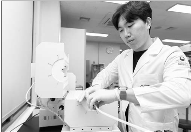
농촌진흥청은 가축분을 열분해로 에너지화하는 열분해 공정에 이산화탄소를 활용함으로써 효율을 높일 수 있다고 밝혔다. 사진은 가축분을 열분해하고 있는 모습이다.
